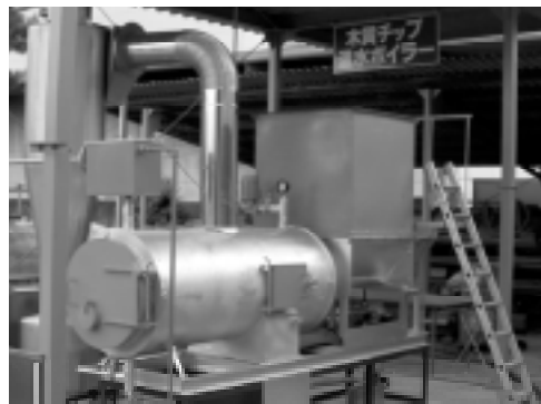
屋外に展示してある温水ボイラー
